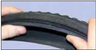
Fissures de vieillissement.
