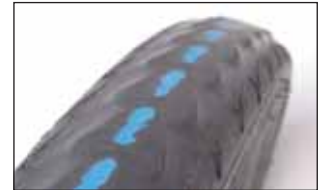
Le renfort anti-crevaison apparaît. Le pneu doit être remplacé d'urgence.
