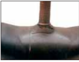
Arrachement du pied de valve.
