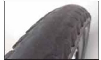
Les profils ont disparu. Il y a encore du caoutchouc. Le pneu peut encore être utilisé.
